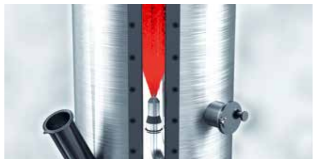
Precursoren werden in den pulsierenden Gasstrom eingespritzt
