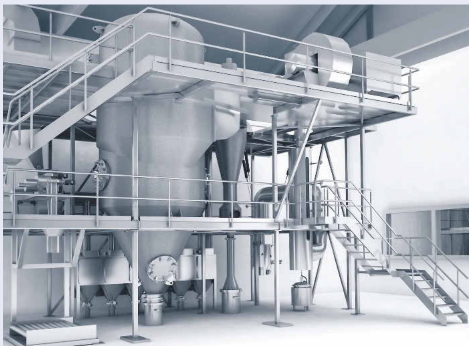
In der Apptec-Anlage wird der Ausgangsstoff als Pulver, Lösung oder Suspension in einen Heißgasstrom gesprüht
